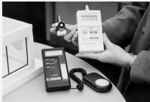
Instrumental de medición: luxómetro estándar y luxómetro escala 1:20
